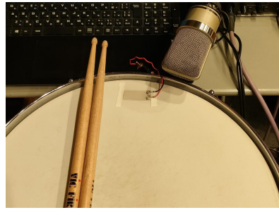
図-1 実験に使用したスネアドラム。打面にピエゾ素子を貼り付け、付近に単一指向性のコンデンサマイクロホンを設置した。いずれもオーディオインタフェースを通じてコンピュータ上の DAW に収録した。
