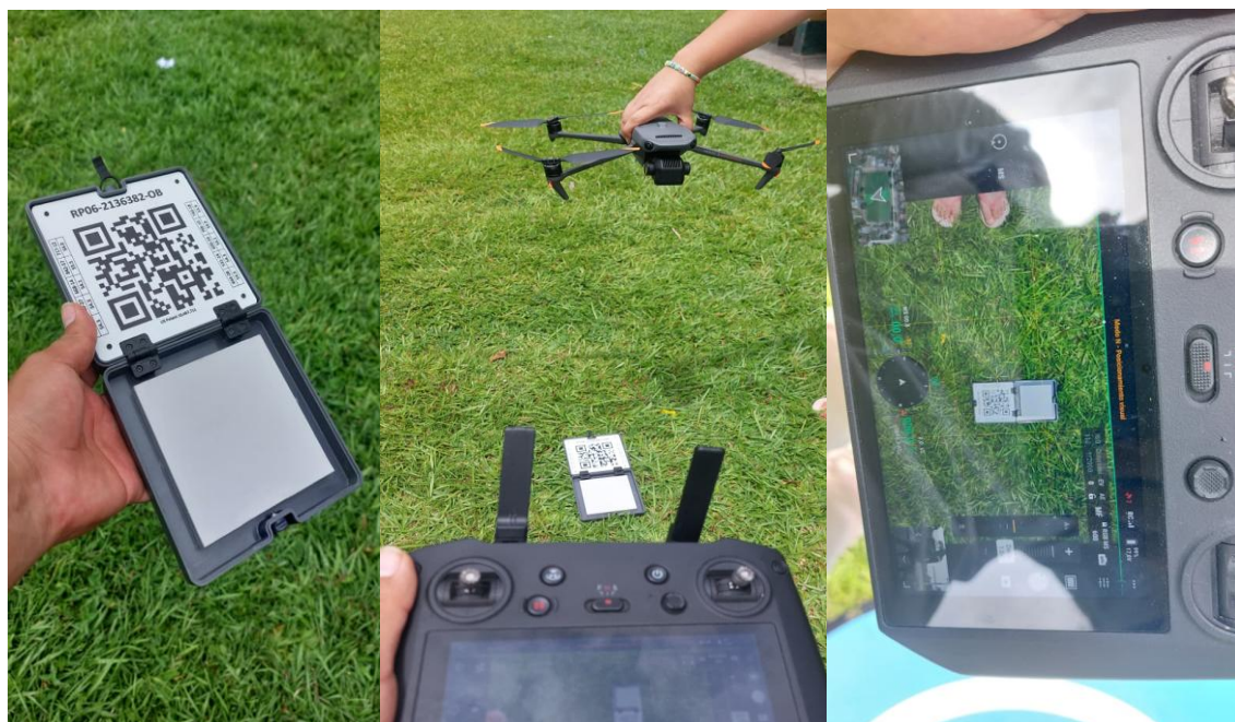
Figura 8. Tomar una foto del panel de calibración antes de iniciar el vuelo y otra al finalizar, para asegurar la correcta georreferenciación y la precisión de los datos obtenidos durante la misión.
