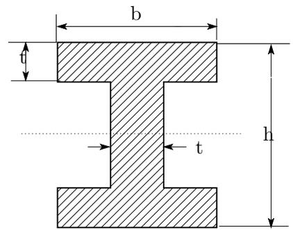
(b) 中立軸に関する断面 2 次モーメントと断面係数の値を求めよ . ただし ,  $h = 100mm$  ,  $b = 90mm$  ,  $t = 10mm$  として有効数字 3 桁までを求めよ . (15 点)
