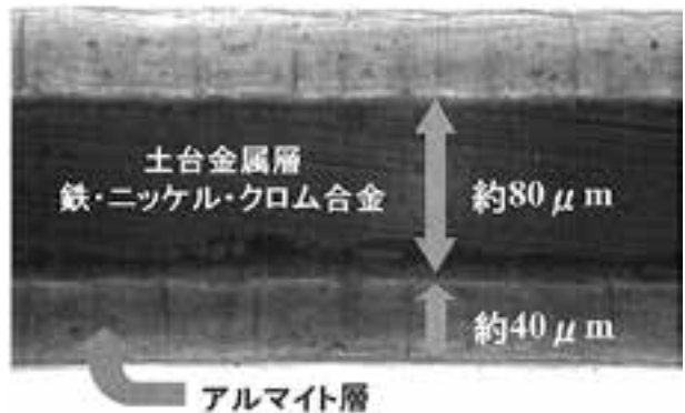
図8 通電加熱アルマイト担体の断面写真
