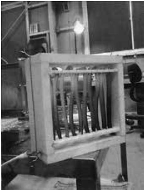
図10 通電加熱試験 (室温から800℃まで5000回の加熱試験にパス)
