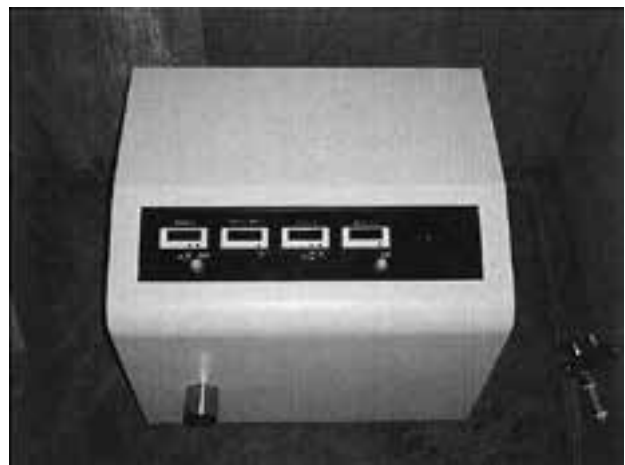
図13 通電アルマイト触媒を用いた脱臭試験装置
