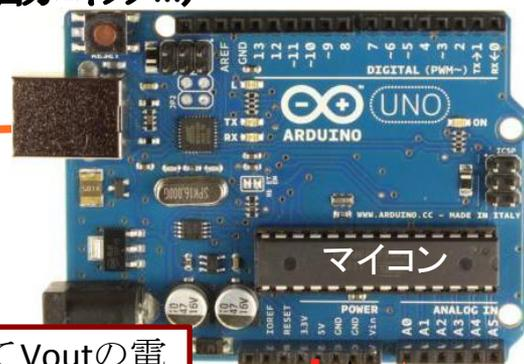
AD変換器によって  $V_{out}$  の電圧を数値化 (AD変換値)。
