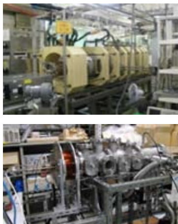
図 3 開発した高密度ヘリコンプラズマ装置例：上から大きいサイズ順に LHPD (Large Helicon Plasma Device : 宇宙科学研究所で開発した世界最大の装置、直径 74 cm、長さ 486 cm)、LMD (Large Mirror Device : 種々の基礎から応用までの研究に寄与)、HFD (High Field Device : 完成当時世界最強磁場 1 T で、 10^{13} \text{ cm}^{-3} の電子密度を十分超える)、SHD (Small Helicon Device : 世界最小口径の 0.5 cm まで達成し更に開発中)
