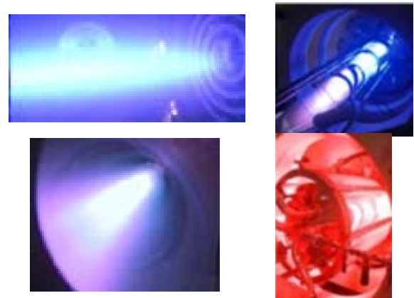
図 4 様々なヘリコンプラズマ光（左上：LHPD でのアルゴンガスを用いた中心部分が青い所謂ブルーモード、外部設置したスパイラルアンテナも見える、左下：LHPD のアルゴンプラズマ、アンテナ部からの写真、右上：LMD のブルーモードとなったアルゴンプラズマ、右下：LMD のネオンプラズマ）
