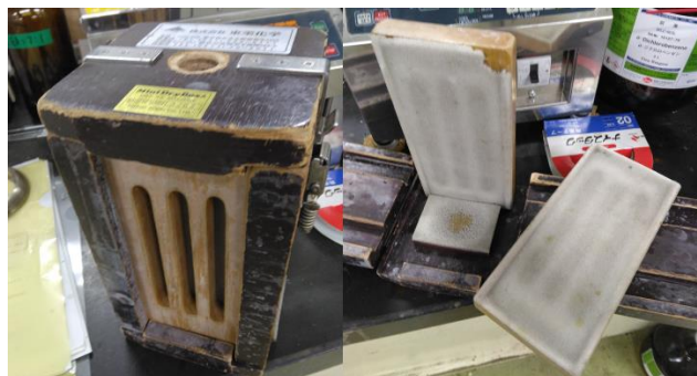
写真 1 実験室のドライアイスメーカー (左: 全体像、右: ばらしたところ) (サイホン式の液化二酸化炭素ボンベに連結して使用する)
