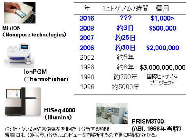
図9 DNA シークエンサーの進歩(電気泳動によるシーケンサーから NGS へ)
