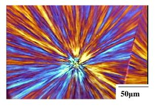
大きな球晶 正負の複屈折が混在 (Mix球晶)
