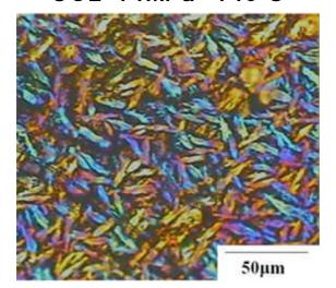
針状結晶 長軸方向に正の光学異方性 分子鎖が長軸方向に配向
