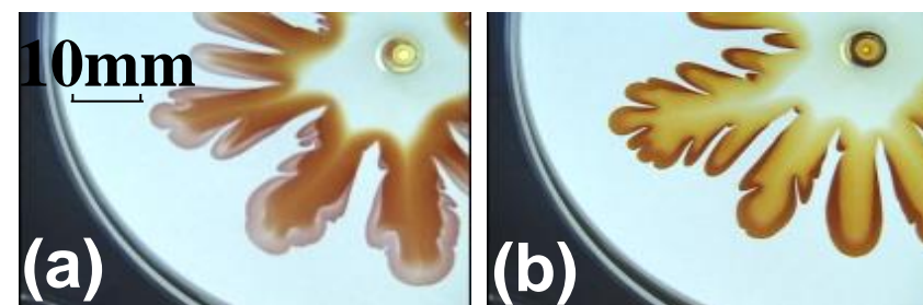
図1: 世界で初めて報告した生成物分布が反応物濃度大きく依存する液相反応流
