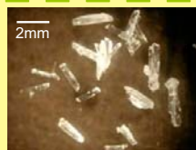
添加物入り溶液から 析出させたアセトアミノフェン
