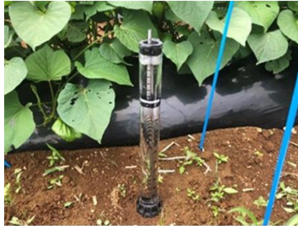
土壌透水性変化測定
