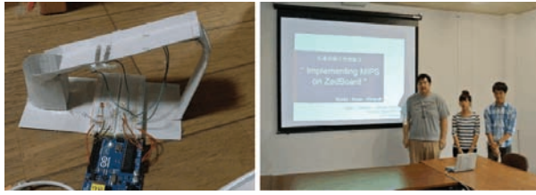
図3 (左) SAIL 科目において、学生のアイディアに基づき製作された Arduino を用いたコインカウント機。(右) 学期末に行われた成果発表プレゼンテーションの様子。
