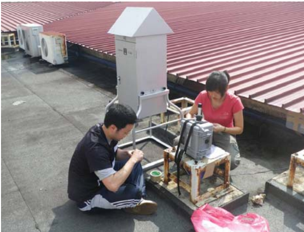
図5 マレーシア・プトラ大学における大気微粒子採取装置（ハイボリュームエアサンプラおよびローボリュームエアサンプラ）の設置作業
